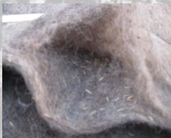
**Le caratteristiche della lana consentono l'impiego delle stuoie preseminate anche in ambienti con substrati poveri.**
